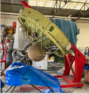
Baie de propulsion avec moteur HM7 & Moteur
