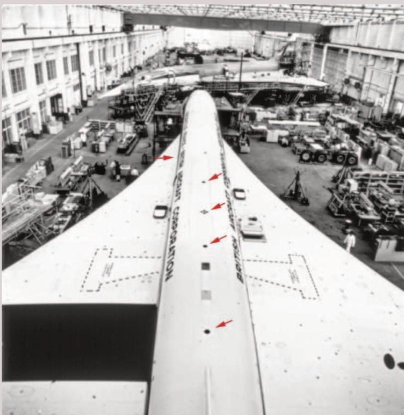
Quatre hublots supplémentaires sont percés dans l'axe de la cabine du concorde 001 et une ouverture en latérale existante (flèches) © aerospatiale
