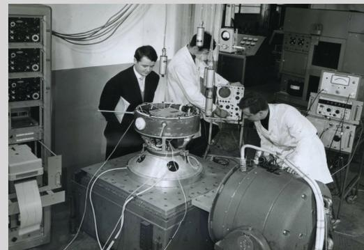
Essai de vibration sur le proto du Satellite A-1 (G. Estibal) @ DR
