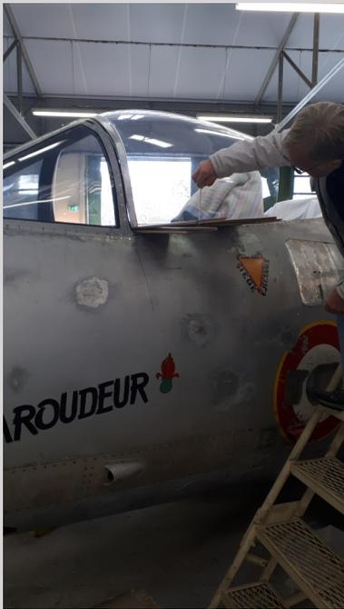
La verrière avant (PMMA) a été présentée sur la structure support prototype et l'ensemble sur le fuselage.
